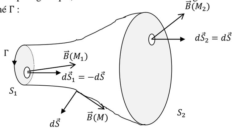
En raisonnant sur la surface  $S$  fermée constituée des surfaces  $S_1, S_2$  et de la surface latérale  $SL$  du tube de champ, on obtient en appliquant
