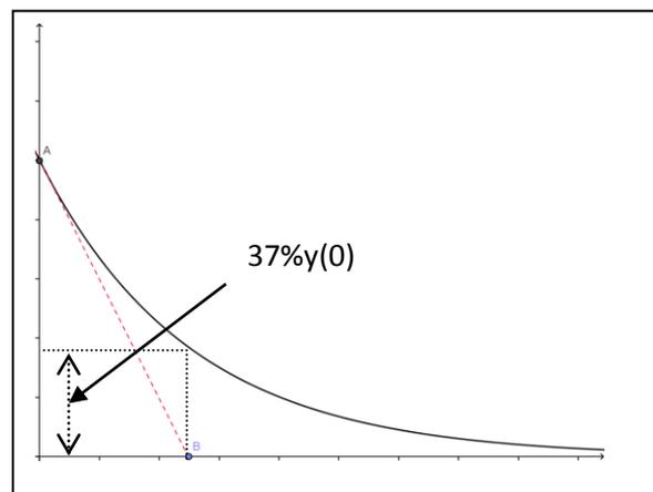
$y$  s'annule au bout d'un temps théorique infini. En pratique, compte tenu de la précision finie des instruments de mesure, le temps du régime transitoire est fini. La durée du régime transitoire est généralement évaluée à  $5\tau$  (cf. paragraphe 3).
